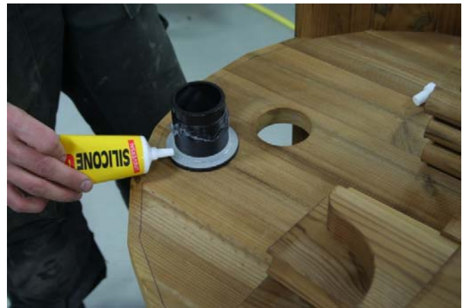
Nyt on hyvä ajankohta asentaa pohjaventtiili. Laita silikoonia kierteisiin.
