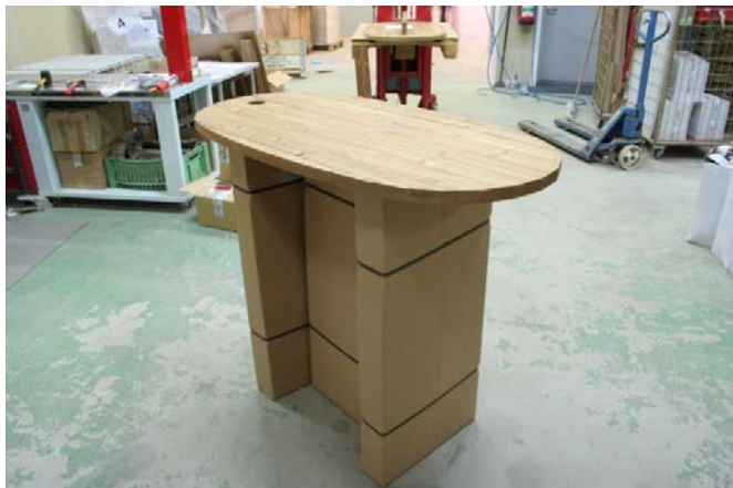
Pohja asetetaan kolmen laatikon päälle. Asennusviiva ylöspäin.
