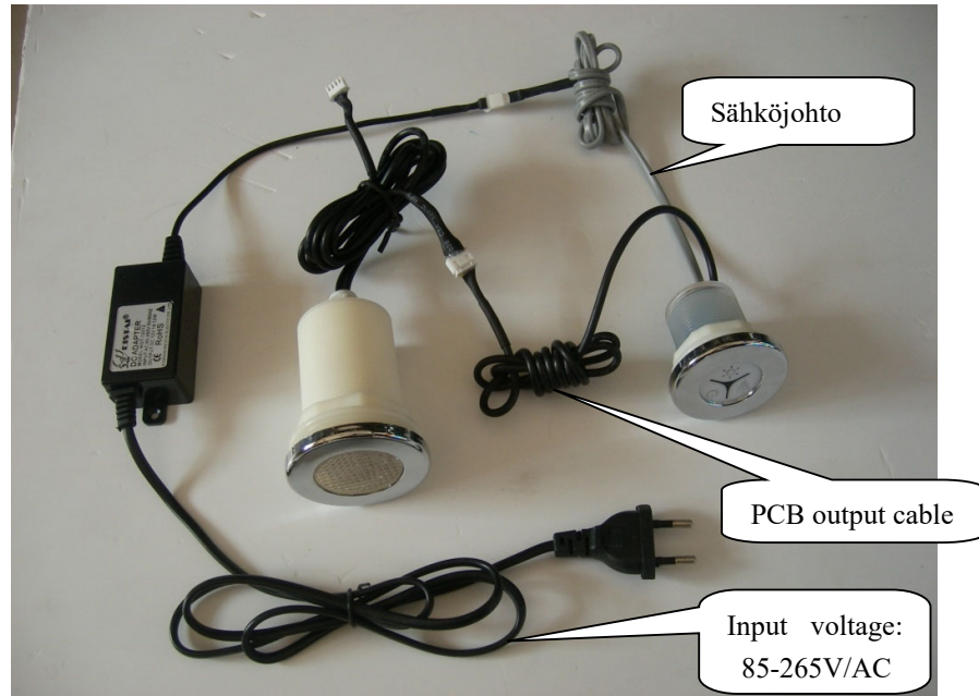
Kuva 1: Sähköadapterin kytkentä, ohjainyksikkö, valo
