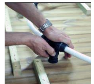
Die Luftventile werden in den Fassboden geschraubt.
