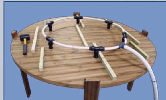
T-kappaleet painetaan ja ruuvataan kiinni ilmaventtiileihin
