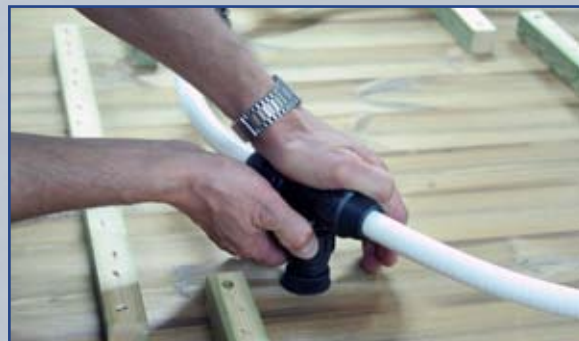
T-styckena trycks och skruvas fast på luftventilerna.
