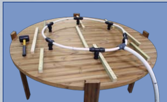
T-styckena trycks och skruvas fast på luftventilerna.
