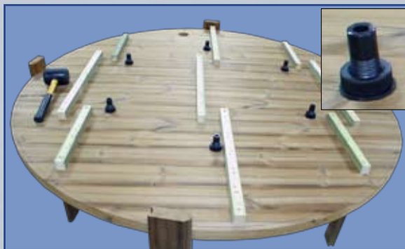
Luftventilerna skruvas fast i botten.
